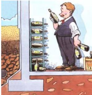
Dans le deuxième cas la réalisation d'un drain périphérique est nécessaire.
